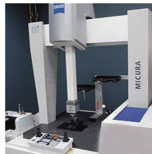
图3 三坐标测量机测量螺纹示意图 Fig.3 CMM measuring the thread
